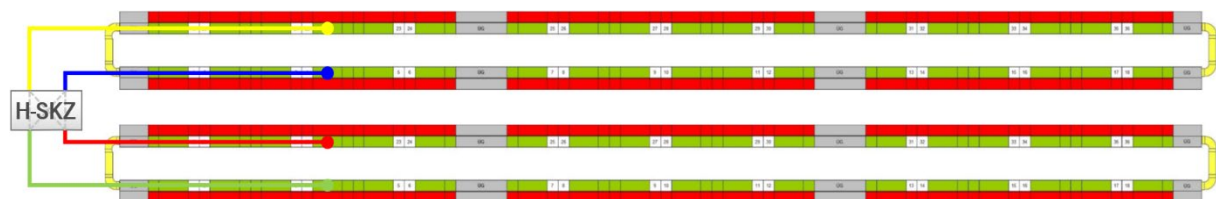
Abbildung 13: Verkabelung von mehreren HVt-Blöcken durch den H-SKZ
