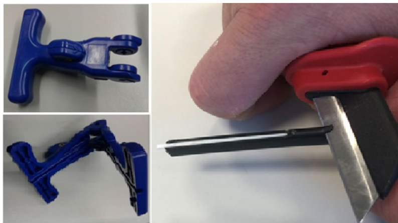
Abbildung 33: Abmantelwerkzeug für o.i. Hauszuführungskabel / Absetzen mit Kabelmesser
