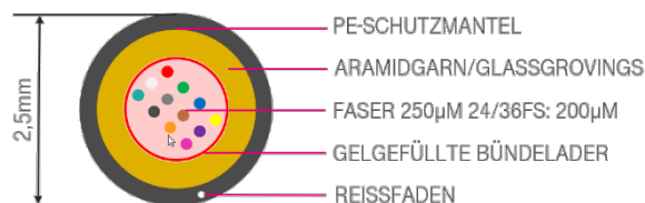
Abbildung 31: Kabelaufbau Mikrokabel
